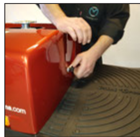
Verwijder de duimschroef en verwijder het accudeksel.
