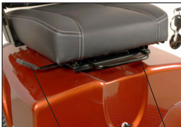
Ontgrendeling voor stoel draaien. Ontgrendeling voor stoel vooruit/achteruit.
